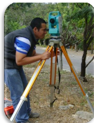
Fig. 14. con el ocular de la plomada óptica fije el punto de observación; dejando fija una de las patas y moviendo las otras dos hasta encontrar el punto.
