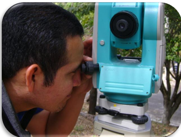
Fig. 13. Enfoque el Punto Topográfico mirando por el ocular de la plomada óptica, gire el ocular para enfocar el retículo, esto le permitirá ver claramente los círculos concéntricos del enfoque del objetivo (Retículo).
