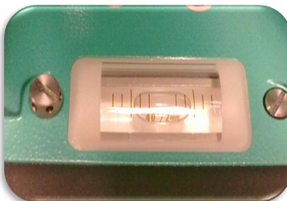
Fig.7.- Gire el instrumento y compruebe que la burbuja de aire está en la misma posición en todas las direcciones. Si no es así repita el procedimiento de nivelado.
