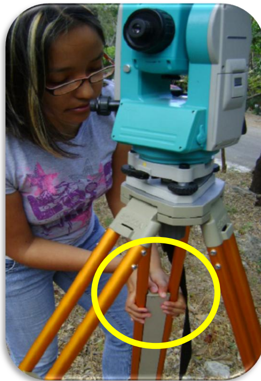
Fig. 19. Se debe tener muy en cuenta la manera de ajustar las patas, se observa en la figura que ambas manos deben sostener los tubos para facilitar el deslizamiento de la barra para obtener una mejor precisión en el nivel circular.
