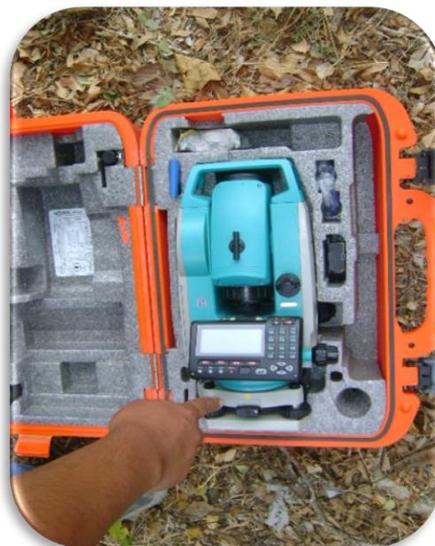
Fig. 9. Una vez abierto el maletín se tiene que poner mucha atención en la manera en como viene la estación de tal manera que no se maltrate.
