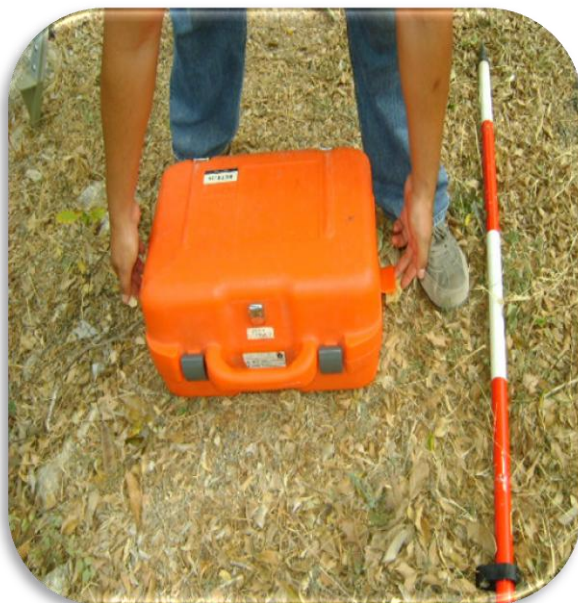
Fig. 8. Se procede abrir el maletín donde está la estación, procurando hacerlo en la posición que se ilustra en la figura.
