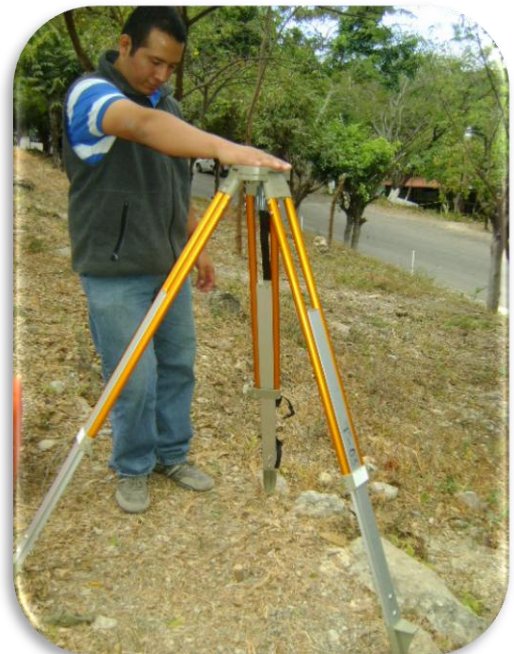
Fig. 7. Hecho lo anterior solo queda verificar visualmente que esta nivelada horizontalmente.
