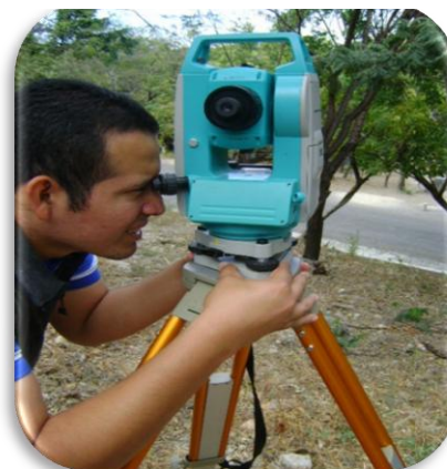
Fig. 16. mirando por el ocular deslice suavemente el instrumento sobre la cabeza del trípode hasta que el punto topográfico este exactamente centrado en el retículo. Vuelva a apretar bien el tornillo de centrado.
