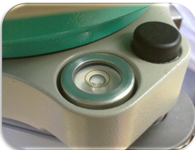
Fig. 19. Centrado de la burbuja
