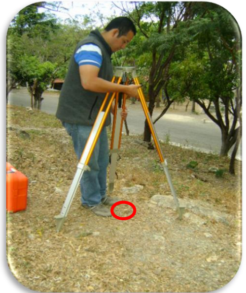
Fig. 5. Se procede a separar las patas con separaciones iguales y sobre el punto observado.
