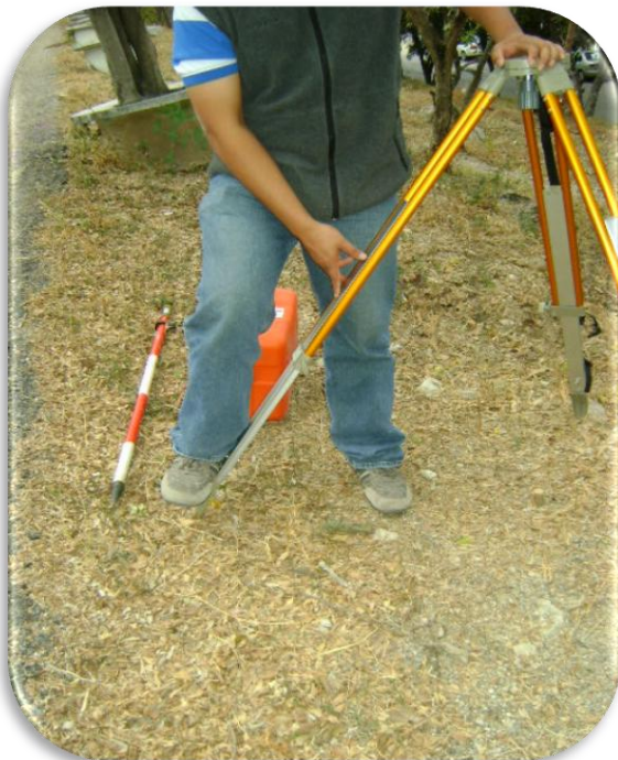
Fig. 6. Se ajusta la cabeza para que quede nivelada, esto se hace asegurando que las puntas de las patas queden seguras y no se muevan. Una vez hecho esto proseguimos a aflojar los tornillos para subir o bajar la plataforma donde se asentara la estación.
