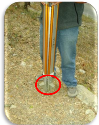
Fig. 2. Se procede a colocar el tripie sobre el punto de observación.
