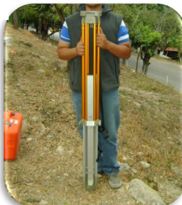
Fig. 3. El tripie se posiciona a la altura de la barbilla.
