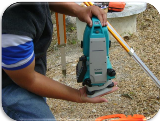
Fig. 11. Se saca la estación con mucho cuidado de tal manera que se usen ambas manos para sostenerla.
